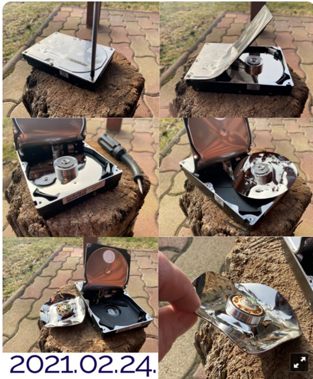
A vizsgált merevlemez roncsolásos adatmegsemmisítése (kemény melő, a csavarhúzó is roncsolódott)
